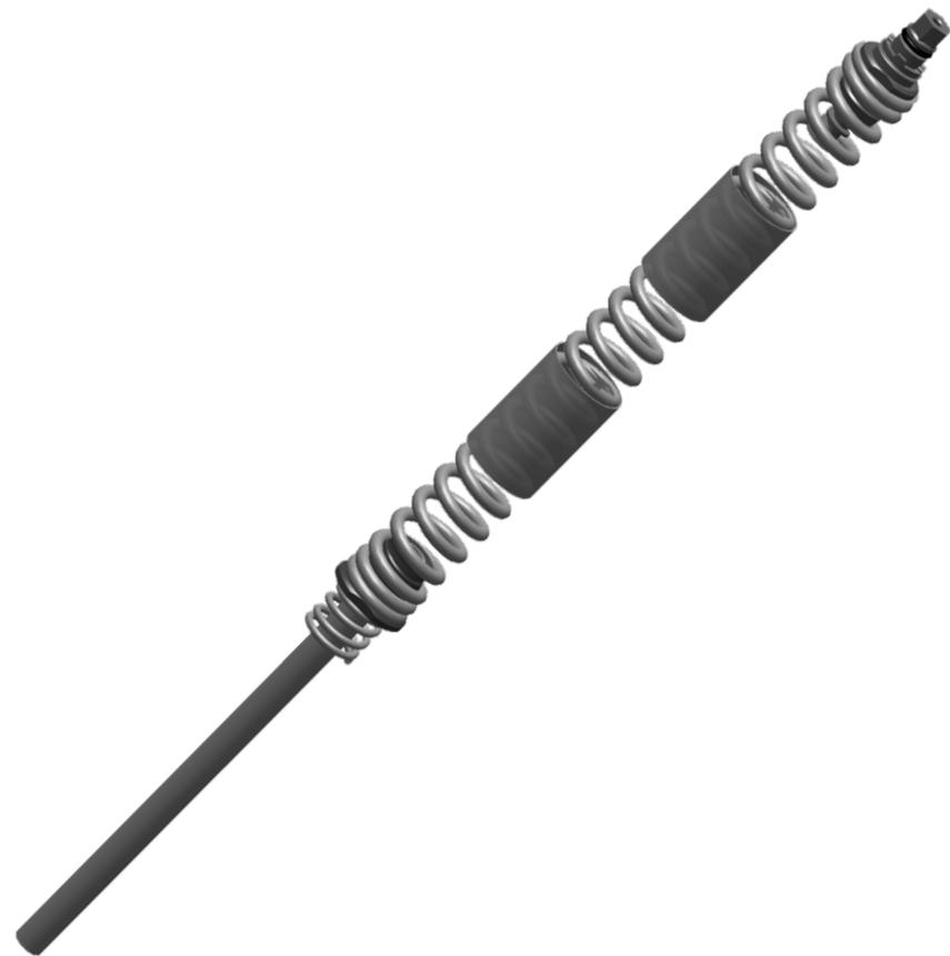
Die Federvorspannungseinstellung kann zur Feinabstimmung der Nachgiebigkeit genutzt werden, die Vorspannung ändert aber nicht die Federhärte und ist kein geeigneter Ersatz für das richtige Schraubenfedergewicht.
