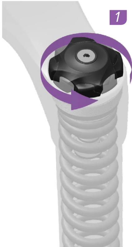
Drehen Sie den Vorspannungseinstellring bis zum Anschlag gegen den Uhrzeigersinn.
