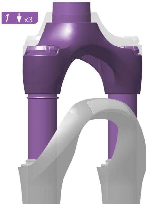
Bitte Sie einen Helfer, das Fahrrad zu halten, stellen Sie sich mit Fahrradbekleidung auf die Pedale und lassen Sie den Dämpfer drei Mal einfedern. Nehmen Sie dann Ihre normale Fahrposition ein – auf dem Sattel sitzend oder den Pedalen stehend.
