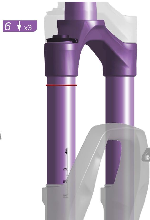
Bitte Sie einen Helfer, das Fahrrad zu halten, stellen Sie sich mit Fahrradbekleidung auf die Pedale und lassen Sie den Dämpfer drei Mal einfedern. Nehmen Sie dann Ihre normale Fahrposition ein – auf dem Sattel sitzend oder den Pedalen stehend.
