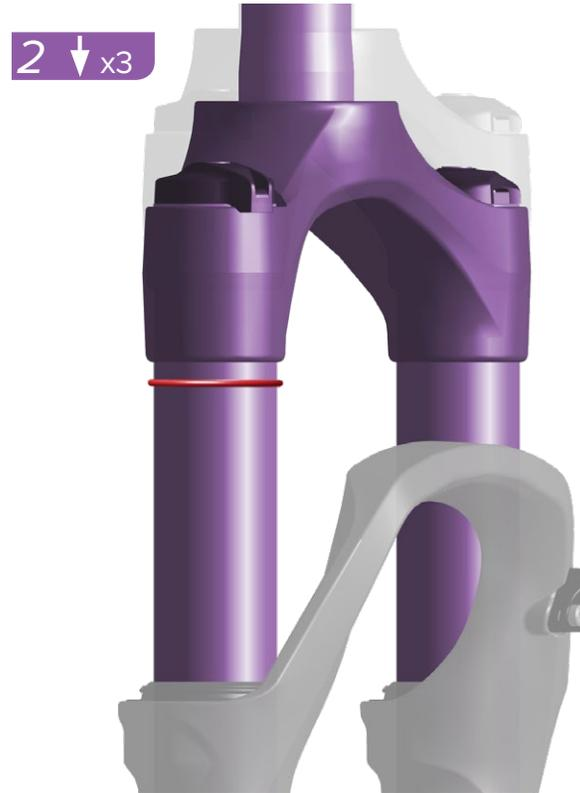
Bitte einen Helfer, das Fahrrad zu halten, stellen Sie sich mit Fahrradbekleidung auf die Pedale und lassen Sie den Dämpfer drei Mal einfedern. Nehmen Sie dann Ihre normale Fahrposition ein – auf dem Sattel sitzend oder den Pedalen stehend.
