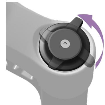
Um die Lowspeed-Druckstufendämpfung zu **erhöhen** (+) (**hart**), drehen Sie den Druckstufeneinstellring im Uhrzeigersinn.
